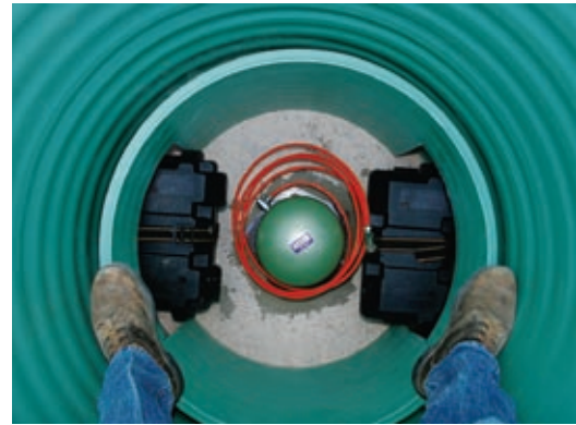
Сейсмометр (зеленая сфера) с поддерживающей его работу электроникой (в черных кожухах) в герметично запечатанном контейнере устанавливается на бетонной подставке, что позволяет устройству сохранять необходимый уровень точности. Так выглядит один из многих сотен приборов, используемых «Наблюдателем Земли».
